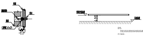
气体管道墙面安装示意图
