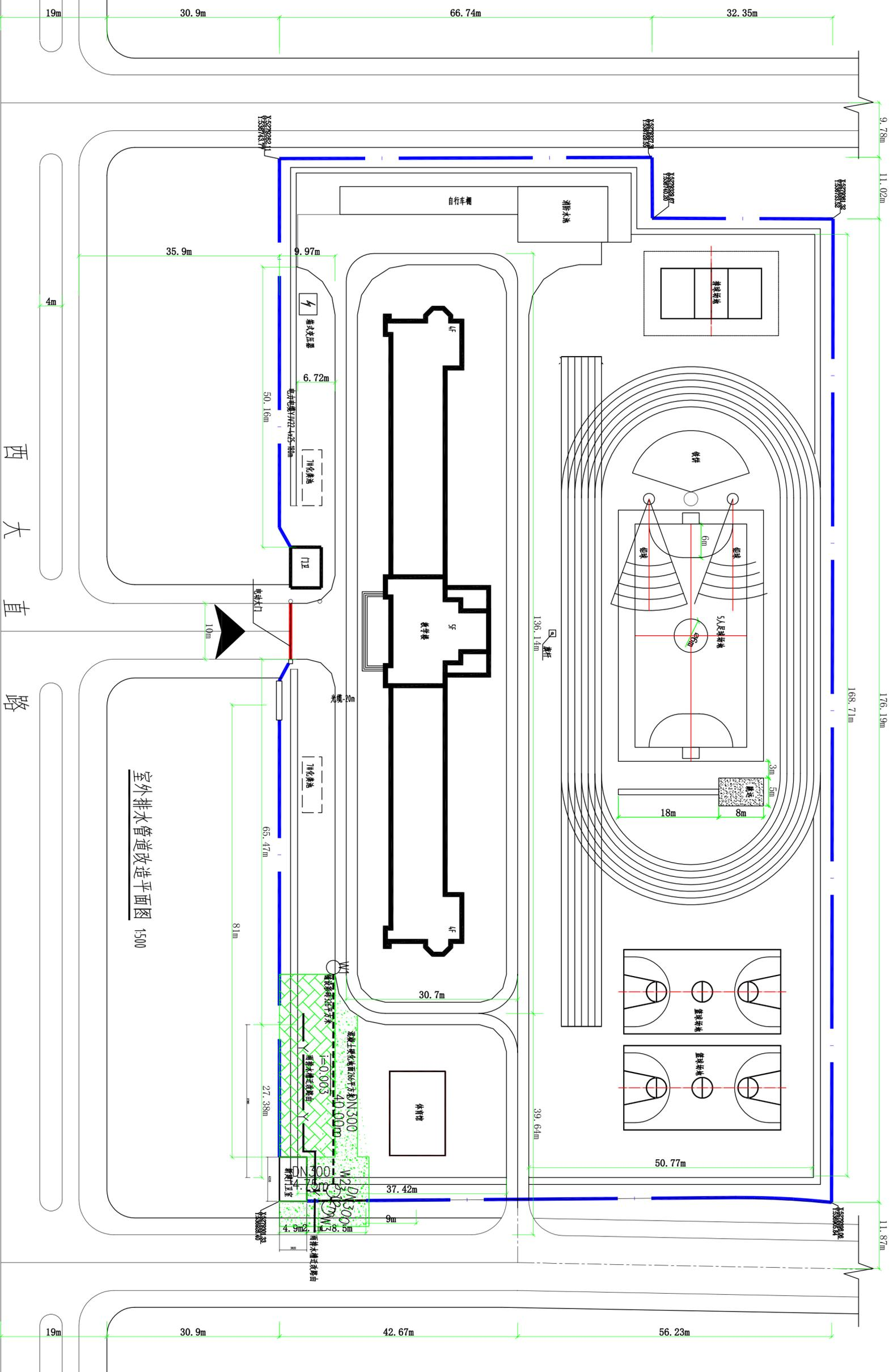
室外排水管道改造平面图 1:500
