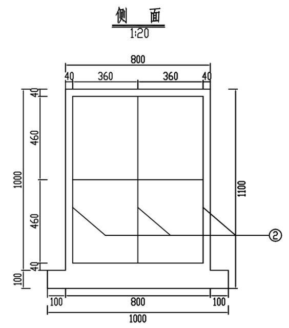
基础箍筋大样图
