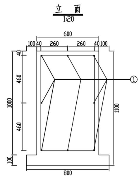
基础主筋大样图
