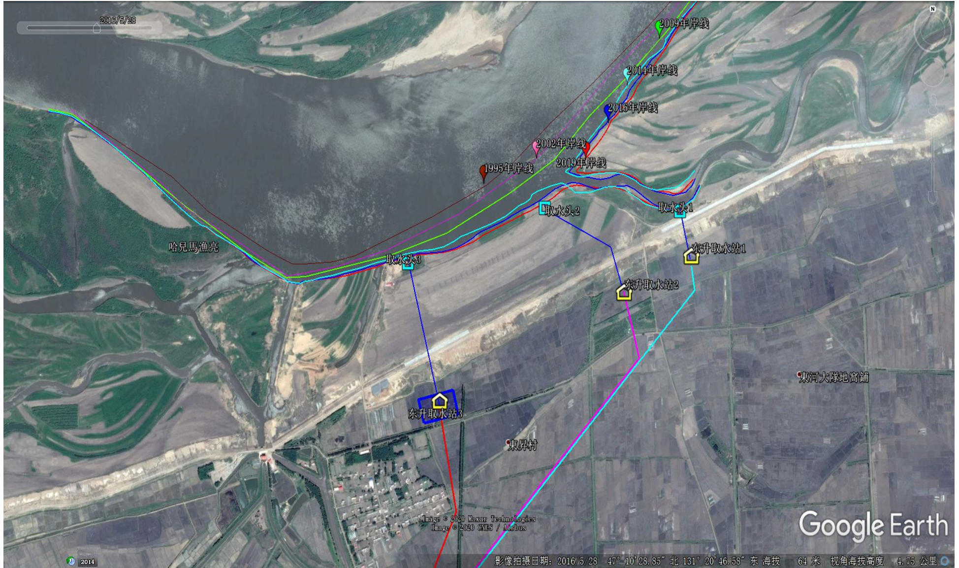
取水泵站站址方案布置图
