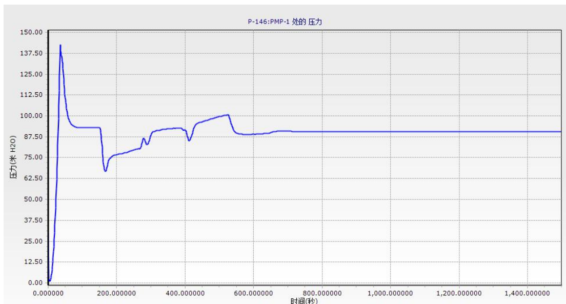
图 2.3-8 水泵出口压力图
