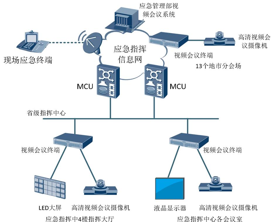
现有的高清视频会议系统采用 IP 传输网络，基于标准的 H. 323 架构，是一个开放的系统，视频协议采用主流的 H. 264 编码同时兼容 H. 261、H. 263 编码，
