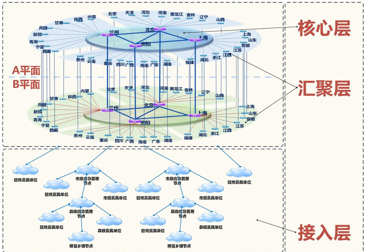
黑龙江省网的省级核心节点和国家应急骨干网黑龙江落地设备对接，省级网络根据所连接的部门分为应急部分和消防部分。目前黑龙江省应急部分已实现省级节点与地市节点的网络互通，其中应急管理厅已接入应急指挥信息网、政务外网、互联网，整体网络架构如下：
