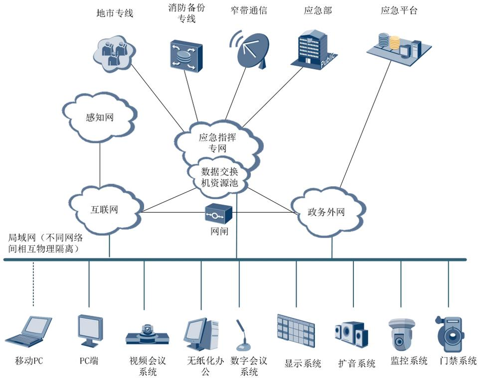
网络及安全部分：应急管理厅将对现有网络进行有效整合。规划后的网络主要由互联网、政务外网和指挥信息网三张网络组成，各网络自成体系，依照出口路由层，核心交换层、接入层，进行分层建设。网络域、安全域、数据业务域，
