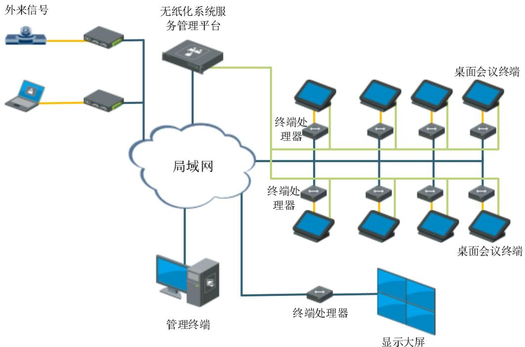
触控无纸化智能终端采用超薄 17.2 英寸电容液晶屏，分辨率达到 4K，屏幕
