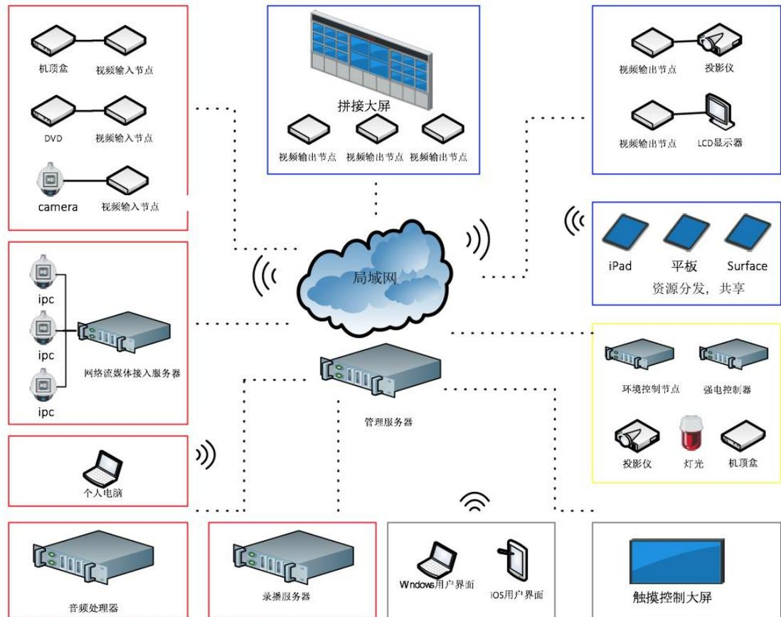
由组网图可以看出，媒体前端并不区分模拟信号还是数字信号，根据媒体前端的信号特点，可以将媒体前端设备变成为交互式系统的媒体源节点。通过解码器，将媒体信号输出到媒体终端，高清输出节点使得大屏幕等媒体终端接入到交互式系统中，成为系统的终端节点。当各个媒体设备成为了交互式系统的节点设备，即被交互式管理主机管控起来。用户可以通过客户端（PC 电脑、智能手机/平板）控制媒体的展示的终端和呈现的方式，实现任何信号，从任何地方来，到任何地方去，以任何想要的方式展示出来。
