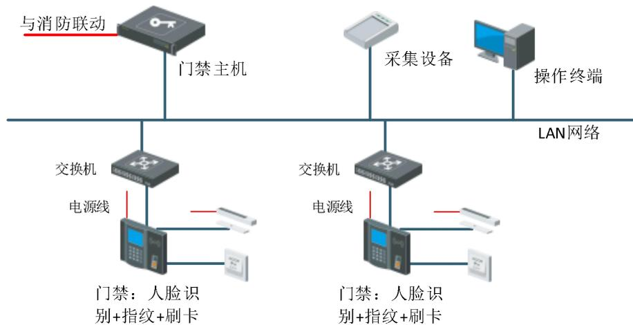
业务技术楼门禁采用门禁主机+电磁锁形式，门禁主机具备人脸识别、指纹识别、密码及刷卡识别方式。采用 7 英寸 LCD 触摸显示屏，200 万像素双目摄像头，面部识别距离 0.2-3m，支持照片视频防假。
