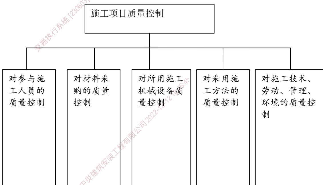
施工项目质量控制因素程序图
